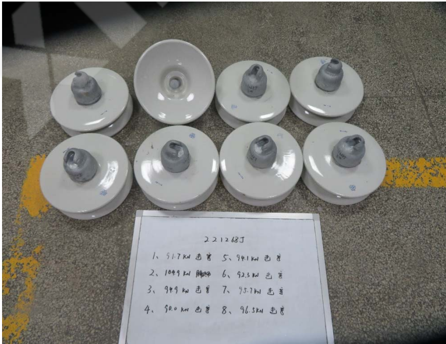
机电破坏负荷试验状况照片
