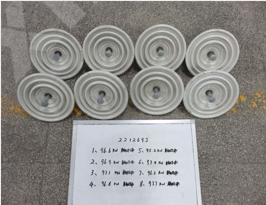
机电破坏负荷试验状况照片
