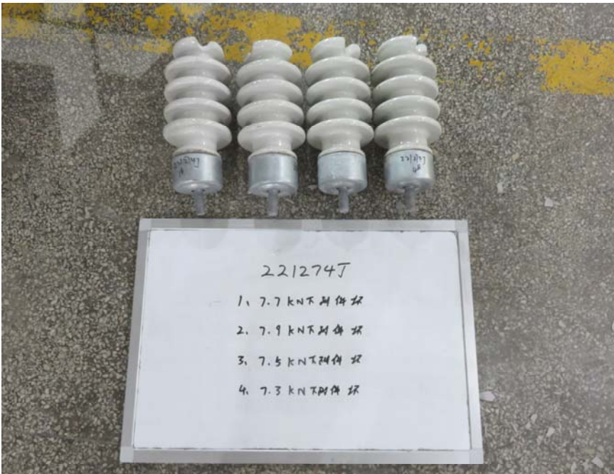
样品破坏状况照片
